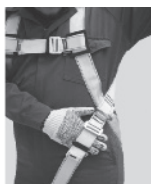
3. Regule todas las hebillas de tal forma que quepa una mano apretada entre la ropa y las correas.
