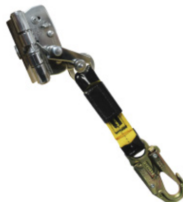
Línea de conexión de 0,25 m y freno con traba para cuerda de 11 a 13 mm Código: FCT - XN025
