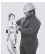
1. Tómelo de la anilla "D" que se encuentra entre las etiquetas de marca y las instrucciones
